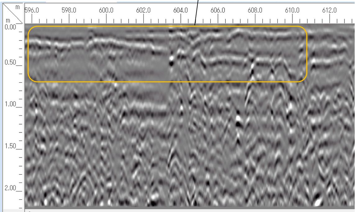
鉄管の埋設モデル。
