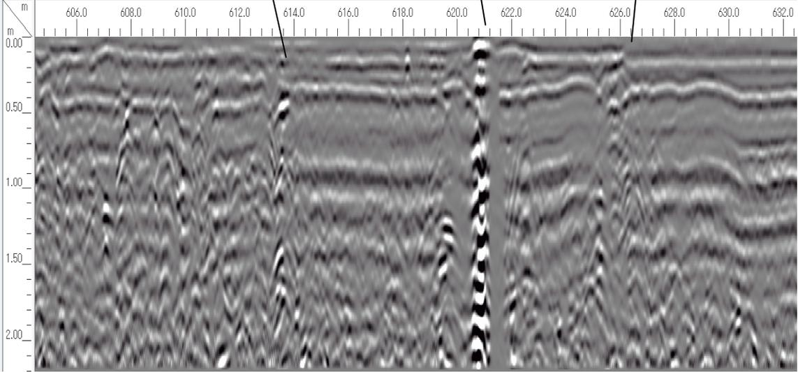
舗装下の反射の連続性が変化しており舗装打ち換え跡と推察される。また反射強度が異なっており材質の違いと考えられる
