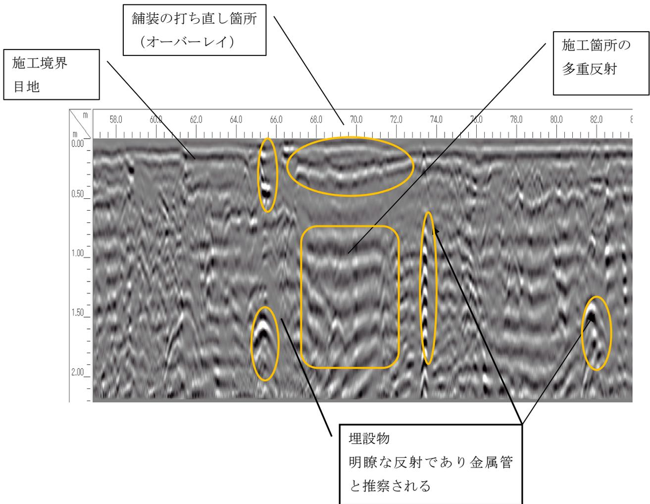
舗装下の反射面の連続性が無く施工あるいは材質が異なっている。
